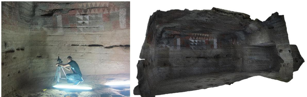
Figura 1. Trabajos de captura de tomas fotogramétricas en el interior de la cámara policromada y modelo fotogramétrico 3D
