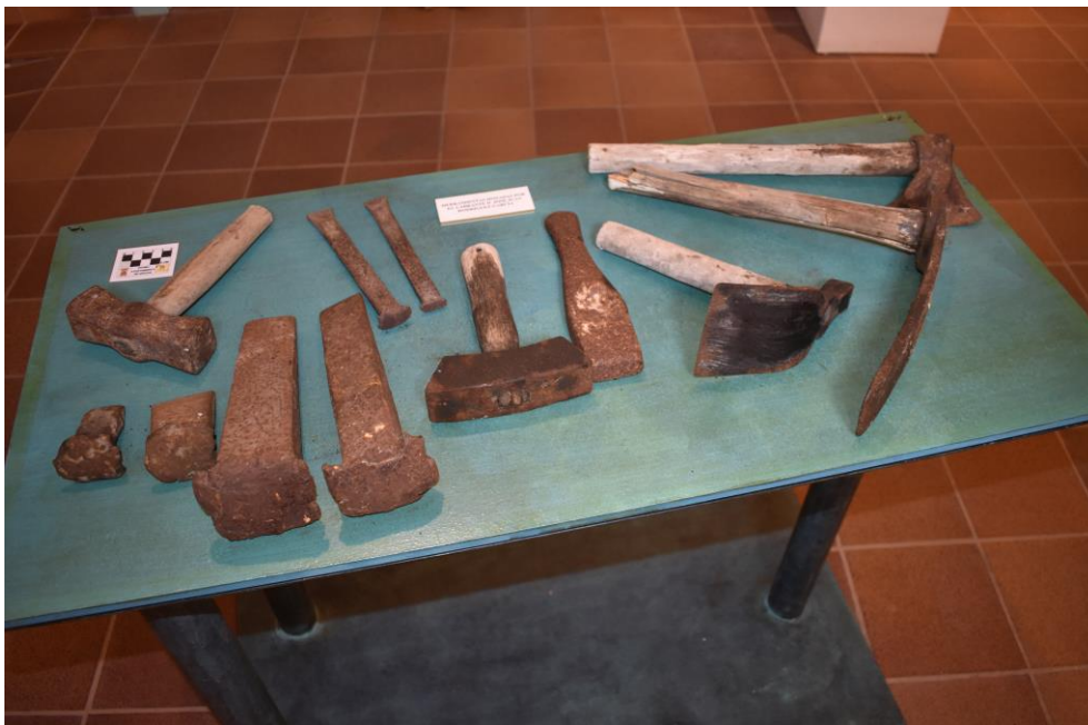
Foto 1: herramientas tradicionales de los canteros, cuñas, maceta, escoplos, maceta., hachuelas y hacha. Centro de interpretación del Labrante, Ayuntamiento de Arucas. Foto: Antonio Jiménez.
