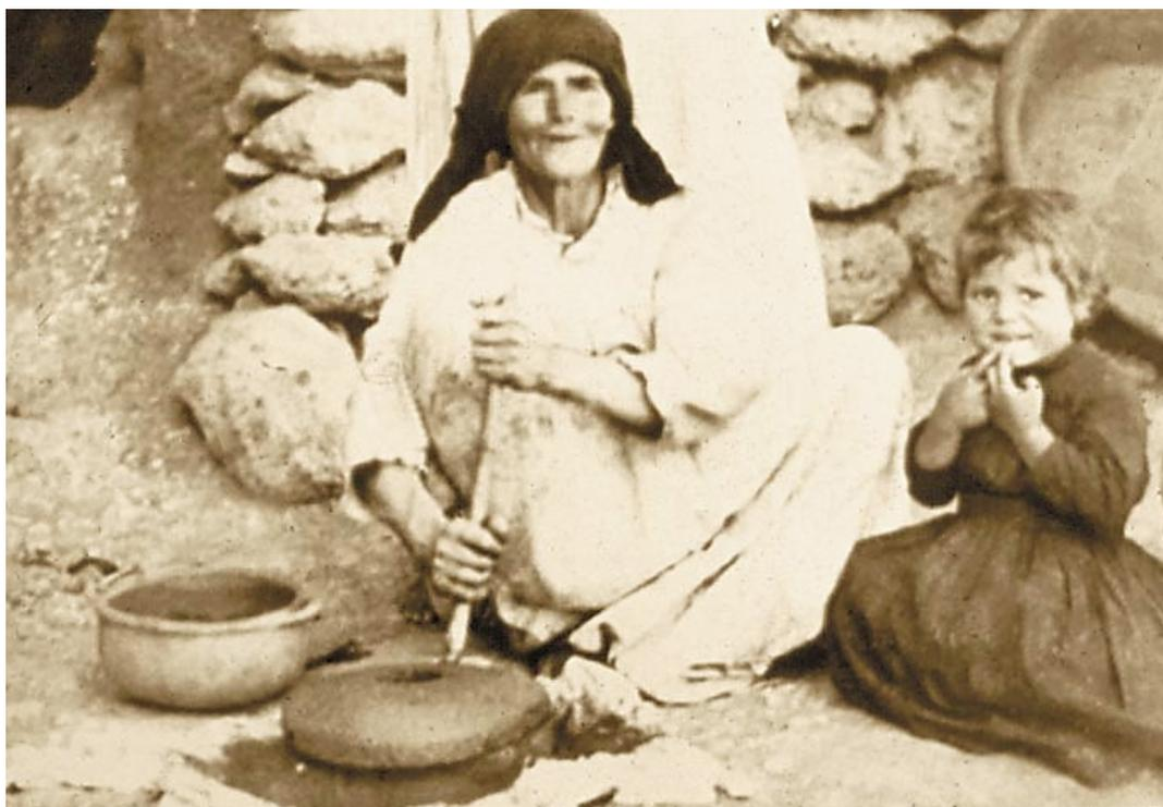
**Figura 1.** Uso del molino manual en el alfar de La Atalaya de Santa Brígida para la obtención de polvo de almagre, necesario para el engobe de la cerámica tradicional. Foto de James Anderson (1891). Fuente: Fondo fotográfico de la FEDAC y ALFONSO GARCÍA (2011), p. 68.
