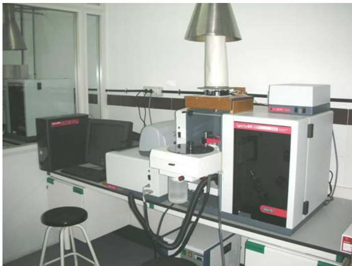
Aparato del Servicio General de Espectroscopia de Absorción Atómica del SEGAI, situado en el departamento de Química Analítica, Nutrición y Bromatología de la ULL. Imagen donada por el profesor Luis Galindo, Dpto. Química Analítica, N.y B
