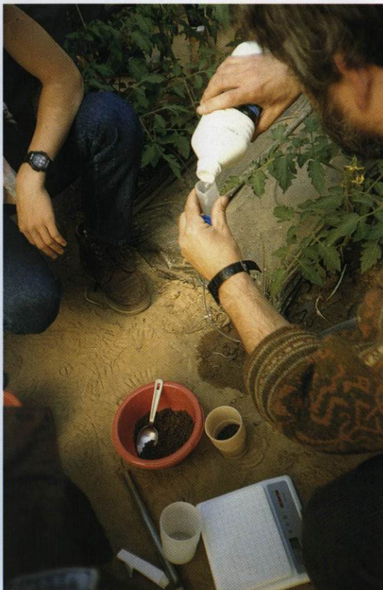
Analisis rápido del contenido en nitrato en un cultivo ecológico de tomate en Francia mediante técnicas colorimétricas.
