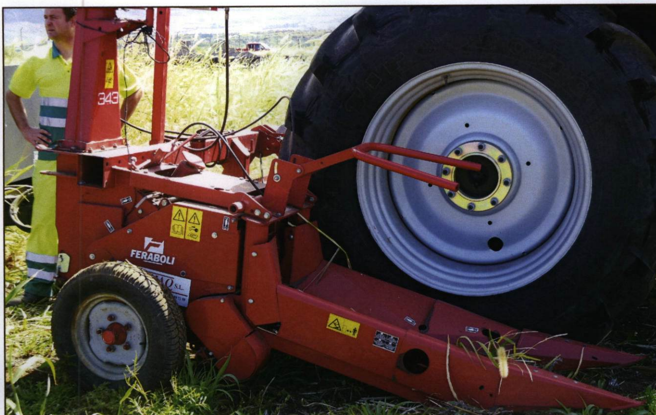
Detalle de la barra segadora y picadora accionable por la tdf del tractor.
