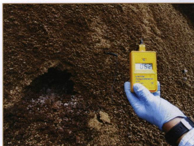
Pila de sólido, obsérvese la temperatura que marca la sonda (a 1 metro de profundidad) de 62°C.
