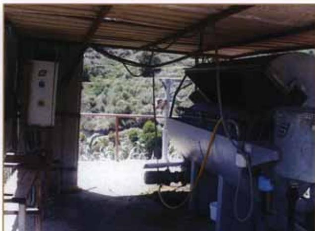
Instalación del separador (tamiz rotatorio), abierto para su autolimpieza
