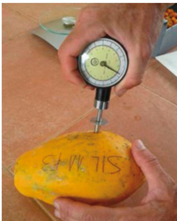
Foto nº10: Medición de la dureza de la papaya
