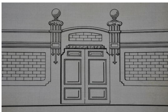
Figura 18. Trilineado de pilastras. Ornato público. Unid. de Instal. 15-41 del archivo Municipal Instal. de S/C Tfe. Arqto: Antonio Pintor. Foto: el autor.
